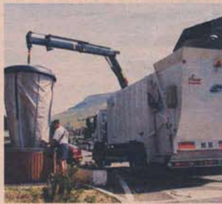
Prednost je podzemnih kontejnera što se lako mogu postaviti u zemlju i na ponton, a prazni ih samo jedan radnik potezom konopca – sve je gotovo za tri minute
