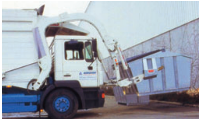
“Frontlader” je vozilo koje dolazi s prednjom stranom do kontejnera, podiže ga preko kabine i prazni sadržaj u kontejner iza kabine.
