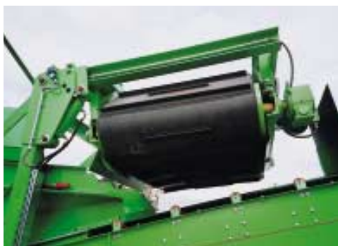
Magnetni odvajač radi na odvajanju jednostavnijeg otpada
