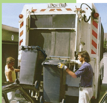
Sustav podizanja i pražnjenja za GMT i MGB posude
